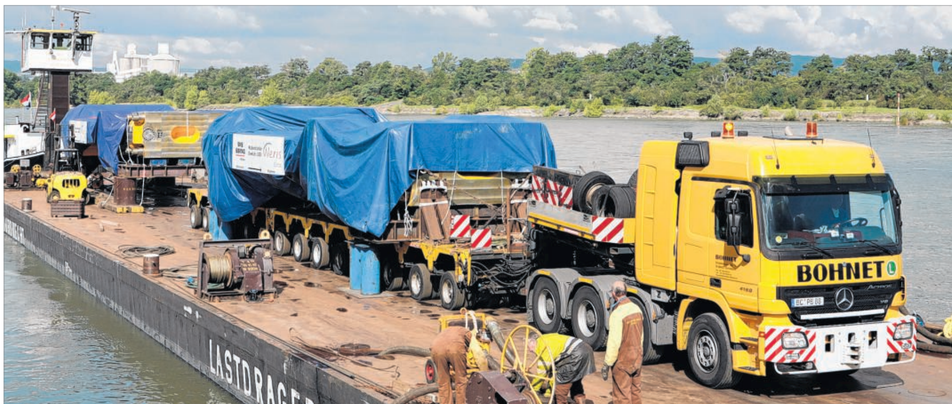
Mit einem Gewicht von 355 Tonnen, etwa so viel wie ein vollbesetzter und -getankter Airbus 340, brach dieser Walzenständer (im Bild die Rheinüberquerung bei Neuwied) vor einigen Jahren den Rekord. Inzwischen hat der Dahlbrucher Anlagenbauer SMS Siemag schon schwerere Kolosse auf die Reise geschickt. Foto: SMS Siemag
