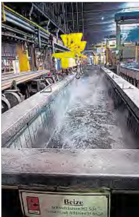
Hier dampft die Beize, in die die Rohre getaucht werden.
