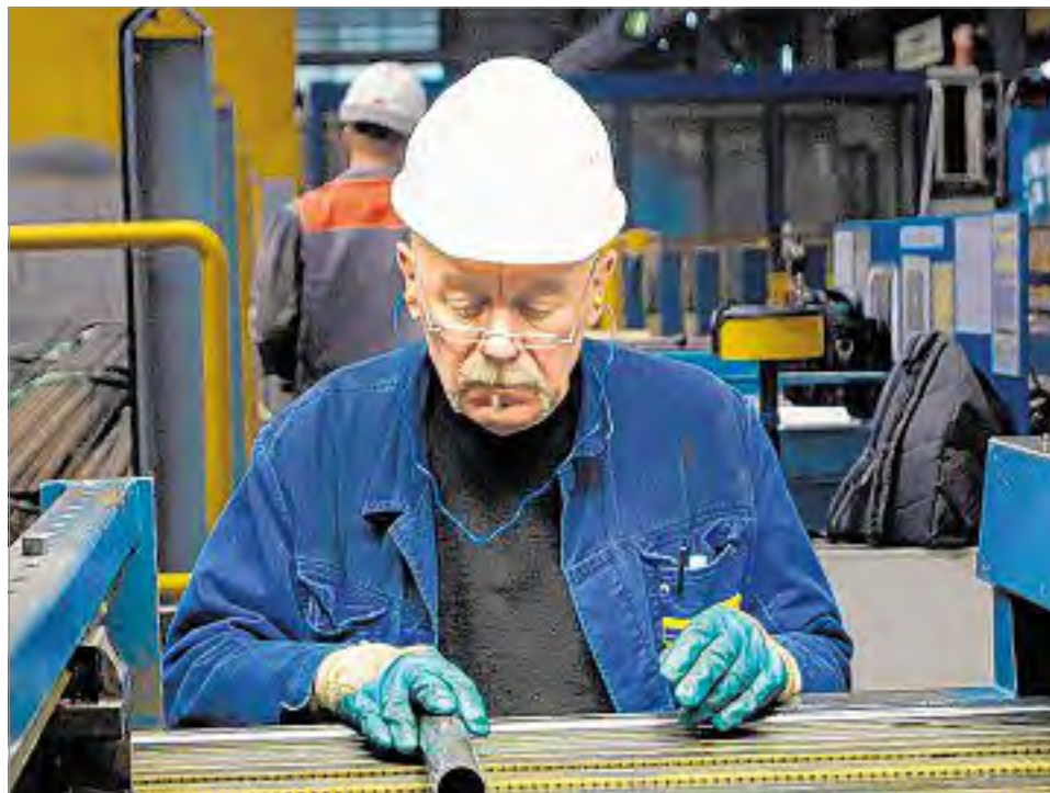
Qualitätskontrolle ist nicht nur Automaten-sache. Erfahrene Mitarbeiter prüfen die Rohre auch mit Auge und Hand.
